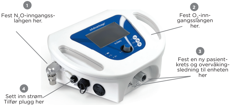
Fig. 1 Koble til forsyningsslangene, pasientkretsen og strømforsyningen
