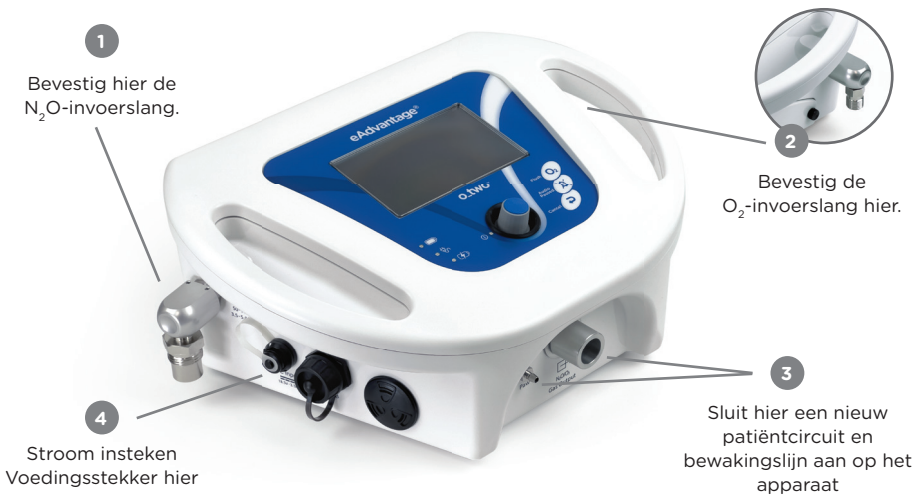
Afb. 1 De toevoerslangen, het patiëntcircuit en de voeding aansluiten
