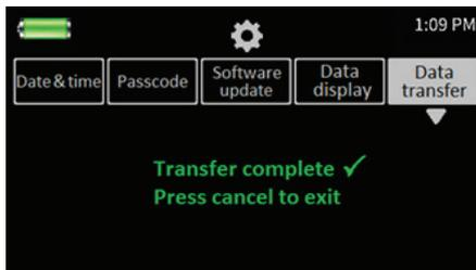
L'utilisateur peut appuyer sur Annuler pour quitter et revenir à l'écran principal ou il se fermera automatiquement si aucune action ne se produit dans les 10 secondes.
