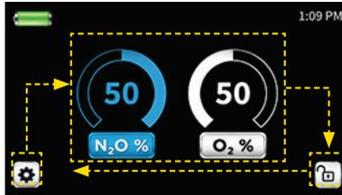
**Note:** Si l'écran est verrouillé, la sélection ou le réglage des modes, du mélange de gaz et d'autres paramètres seront désactivés. Déverrouillez l'écran pour activer ces modifications.
